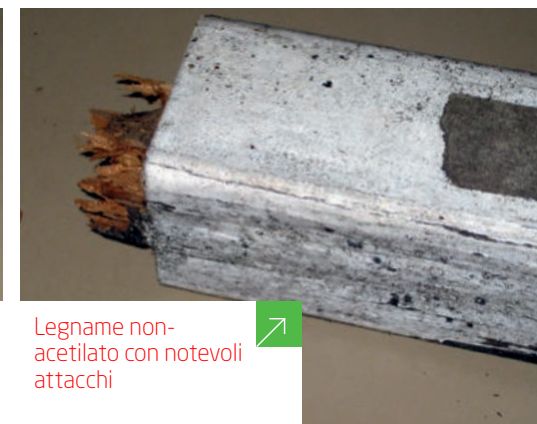
Legname non-acetilato che mostra segni di putrefazione e decadimento
