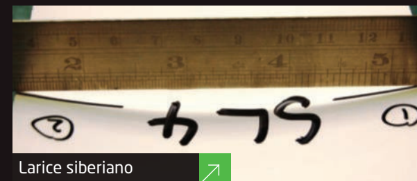
ROTTURA INTERNA TRASVERSALE COMPARATIVA DEI PROFILI DI RIVESTIMENTO
